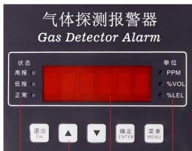
气体浓度单位 检测数值显示窗口 操作按键 工作状态：正常、低报警、高报警
